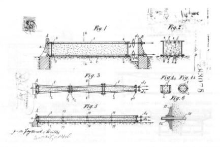
Figure 6 Italian patent n. 283075 by E. Freyssinet and J. Séailles: *Processo di fabbricazione di pezzi in cemento armato*, October 1st 1929 (Archivio Centrale dello Stato)
