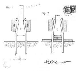
Figure 11 Italian patent n. 389946 by G. Colonnetti: Dispositivo per la messa in tensione e l'ancoraggio delle armature nelle strutture in conglomerato cementizio, March 3rd 1941 (Archivio Centrale dello Stato)
